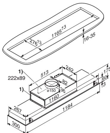
1) Raccordement pour canal d'évacuation d'air de section rectangulaire 222 x 89 cm, alternativement vers l'arrière et vers la gauche.
