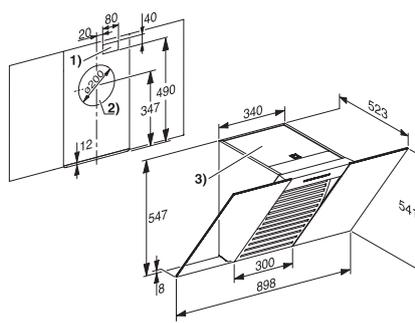
1) Passage pour le raccordement électrique.
