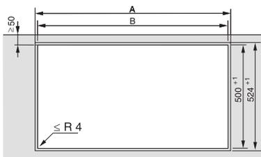
Toutes les dimensions sont indiquées en mm. Si plusieurs éléments sont installés, une distance de 2 mm doit être respectée entre chaque élément. Calcul des dimensions de la découpe A = largeur totale des éléments + 2 mm de distance entre les éléments + 2 mm à droite et 2 mm à gauche, calcul des dimensions de la découpe B = largeur totale des éléments / 2 mm de distance entre les éléments - 12 mm à droite et 12 mm à gauche.
