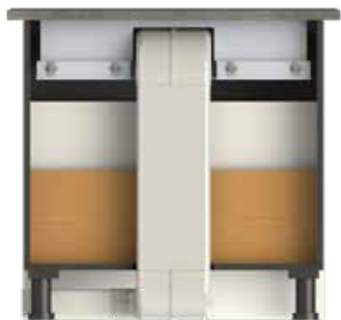
Exemple de montage - largeur de l'armoire min. 900 mm
