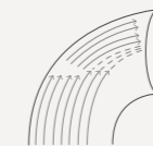
Tekening van een bocht van 90° waardoor de luchtstroom circuleert.
